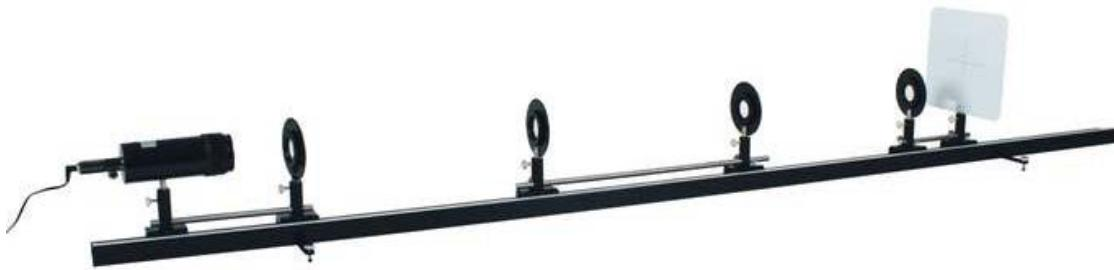
L'objet à l'infini est modélisé au moyen d'un objet et d'une lentille convergente  $L_1$  positionnée de telle sorte que l'image qu'elle forme de l'objet soit située à l'infini. C'est cet objet à l'infini qui est ensuite observé par la lunette astronomique.
